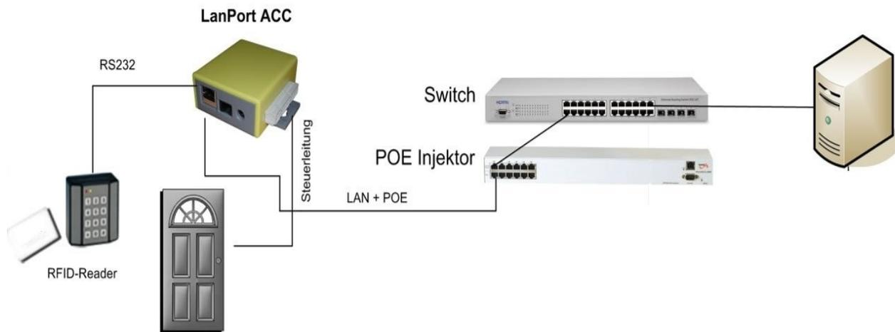
Wir benötigen **keine 220V Wechselstromkreise** zu den Türen. Für den Datentransport und die gesamte Stromversorgung reicht ein einziges Netzkabel. Das macht die Installation und die zentrale unterbrechungsfreie Stromversorgung sehr einfach und preiswert. Außerdem werden Änderungen im Schließplan sofort an alle Türen weitergegeben.
